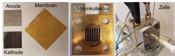
Abb. 3. Alkalische Wasserelektrolysezelle und deren Einzelkomponenten.
