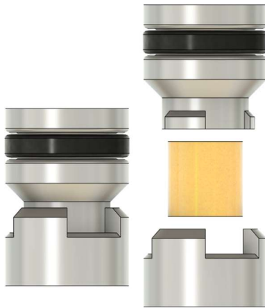
Abbildung 54: CAD-Darstellung der Festbett-Enzymkartusche zur Integration immobilisierter UPO-Enzyme in einen kontinuierlichen Reaktor. Links: montierter Zustand mit O-Ring-Dichtung. Rechts: Explosionsdarstellung mit Kartuschengehäuse und eingesetztem Enzym/Hefezellen-Festbett.
