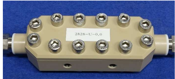
Abbildung 51: Mikro-Festbettreaktoren für die Tandemkatalyse: links geöffneter Edelstahlreaktor mit gepacktem Kanal (gefriergetrocknete Hefezellen mit immobilisierten UPOs), rechts geschlossener PEEK-Reaktor.
