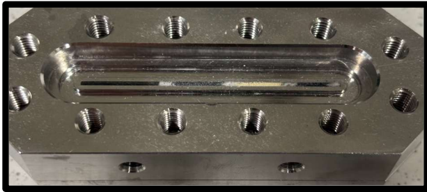
Abbildung 50: Mikro-Festbettreaktor für die Tandemkatalyse - geöffnete -Reaktorhälfte mit gepacktem Kanal, befüllt mit gefriergetrockneten Hefezellen mit über Yeast Surface Display immobilisierten UPO-Enzymen.
