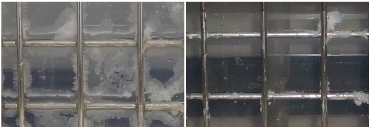
Abb. 2: Polymerfolie vor und nach der Belagentfernung
